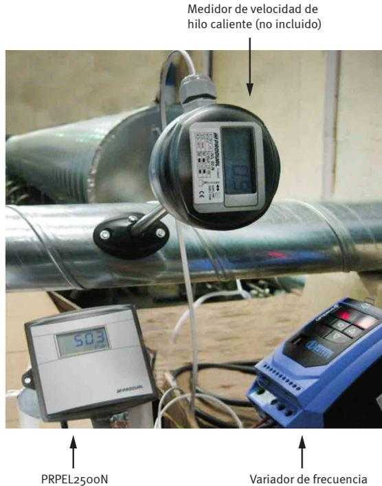
Las pruebas deben realizarse conectando la toma de impulsión al ventilador y posteriormente conectando la toma de aspiración del ventilador; para realizar así la prueba de presión positiva y presión negativa.
